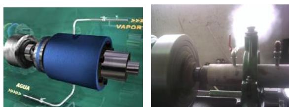
Figura 3. Método de calentamiento por fricción (Guasumba, J., 1993-2014)
