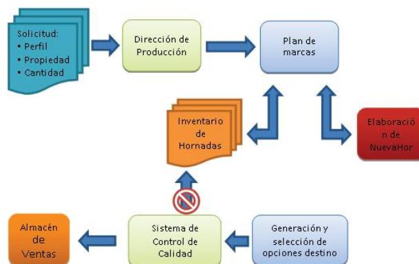
Figura 3. Concepción general del sistema de dirección de la utilización del acero
